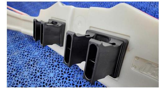
Carénage avant **modèle Homologué CIK 2022 obligatoire** et monté avec le kit de montage homologué CIK/FIA 2022 sauf Mini et Mini Rookie. Barre de pare-chocs avant ancienne homologation autorisées (Règlement CIK Dessin technique N°2c et 2d).
